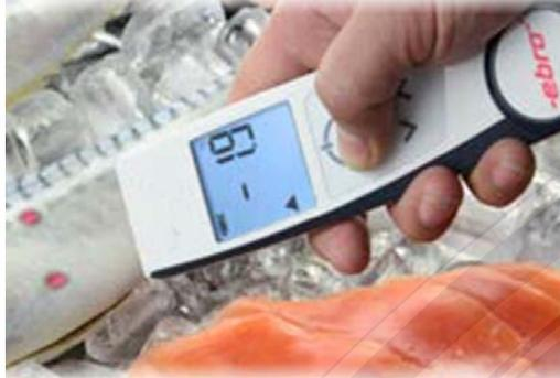
Termómetro Dual con sonda plegable de penetración y sensor infrarrojos.
