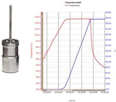
El KIT de pasteurización y esterilización consiste de un registrador para altas temperaturas cod.04958, una interfase y software de evaluación y programación cod. 04957.
